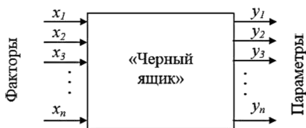
Рис. 1.7. Схема представления объекта исследований в виде «черного ящика»
