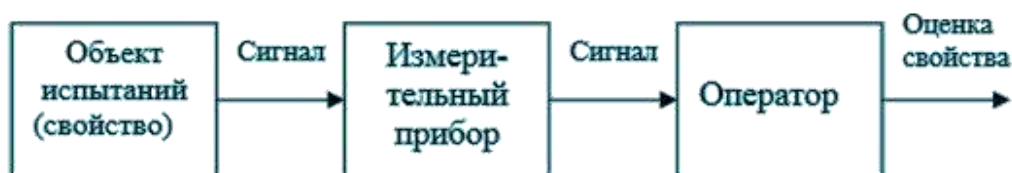
Рис. 1.4. Простейшая схема измерительного эксперимента
